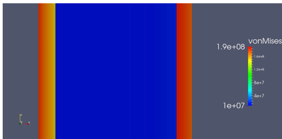
Figura 28: Tensão equivalente de Von Mises \sigma_{vm} em presença do efeito térmico.
