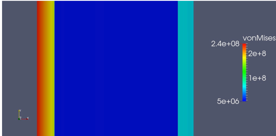
Figura 24: Tensão equivalente de Von Mises \sigma_{vm} em ausência do efeito térmico.
