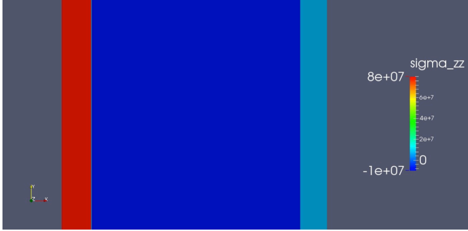
Figura 22: Tensão axial \sigma_z em ausência do efeito térmico.
