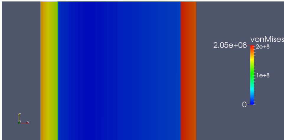
(b) Tensão equivalente de Von Mises \sigma_{vm} em ausência do efeito térmico.
