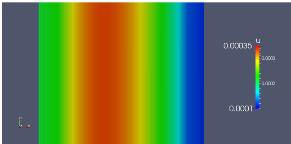
Figura 25: Deflexão radial u_r em presença do efeito térmico
